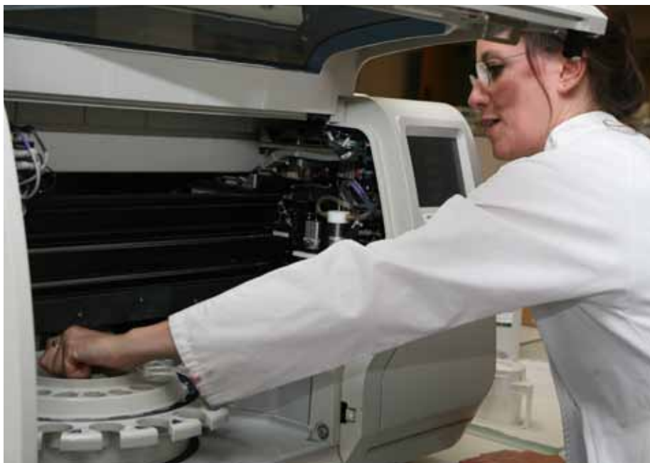
Laboranten plaatsen de stalen per twintig in een carrousel.
