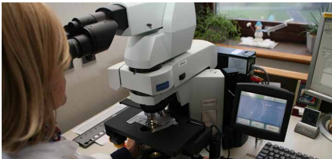
De volautomatische microscoop screent alle cellen in het preparaat digitaal en pikt de meest afwijkende cellen eruit.
