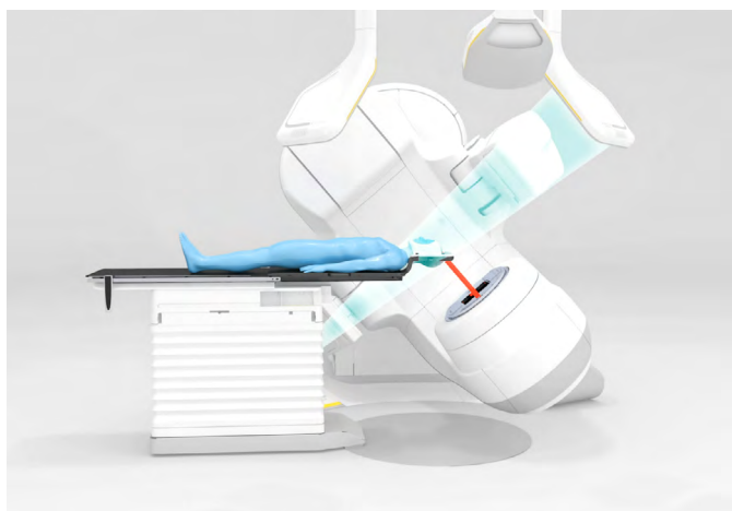
▲ Fig. 3. Illustratie van stereotactische radiotherapie van een hersenmetastase via een stralenbundel (rood) met onlinecontrole van de positie van de schedel aan de hand van radiografieën (cyan) en monitoring van de lichaamsoppervlakte (blauw)
