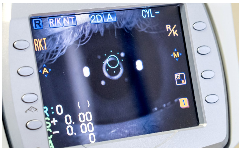
▲ Scherf van de automatische refractometer waarop verschijnt wat de refractiefout is (myopie, hypermetropie, astigmatisme). Deze kan ook de oogdruk meten.
