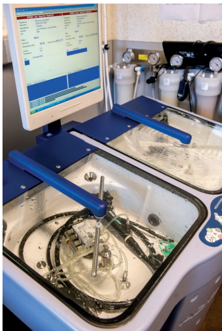
Momenteel maakt de dienst Maag-, Darm- en Leverziekten gebruik van een modulair desinfectiesysteem voor de flexibele scopen.
